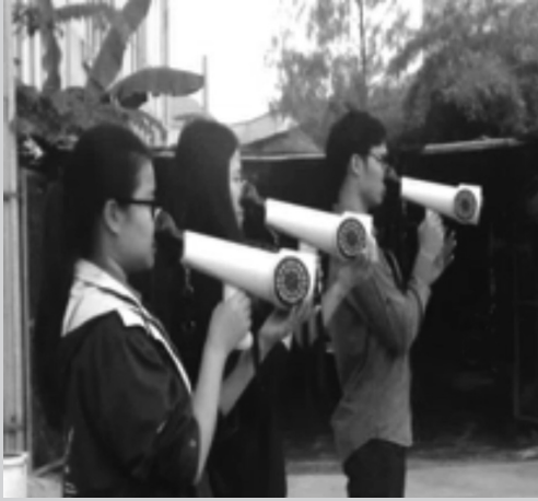
รูปที่ 1 เครื่องมือตรวจวัดกลิ่นในบรรยากาศภาคสนาม (Nasal Ranger) และหลักการทำงาน
