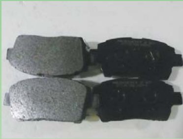
รูปที่ 3 เบรครถยนต์มีแอสเบสตอสเป็นส่วนประกอบ
